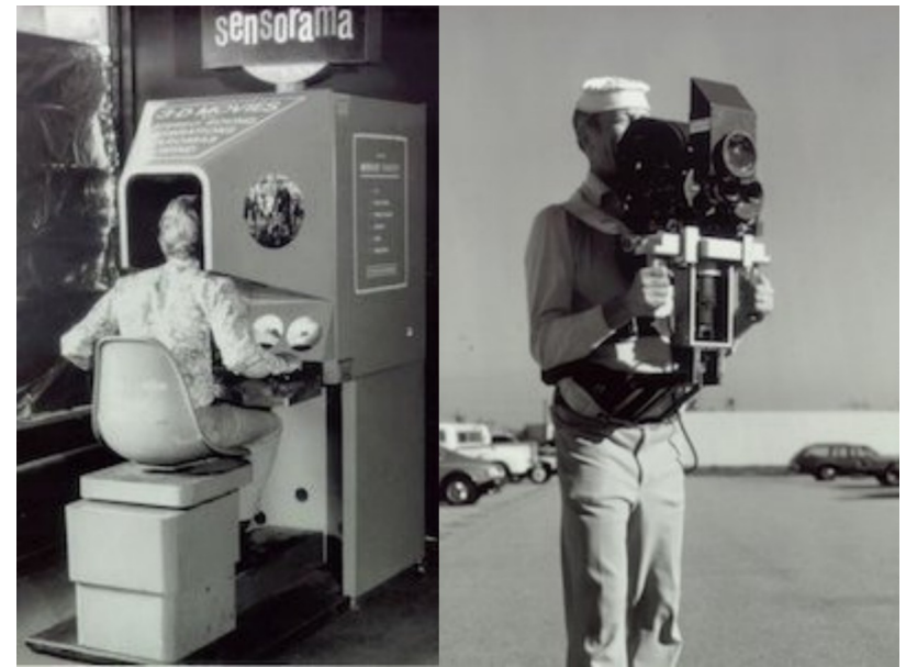
Sensorama 1950 (3D projekce, stereo zvuk, ventilátory, čichové stimuly, vibrující židle)
