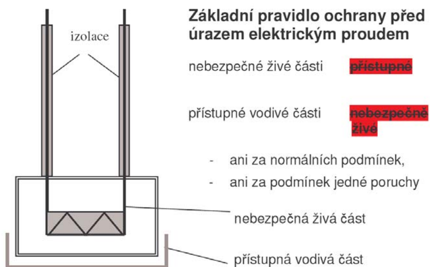
Obr.4.1. Objasnění pravidla ochrany před úrazem elektrickým proudem, bezporuchový provoz
