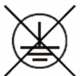
Obr. 5.4. Označení kovových částí na povrchu zařízení třídy II.
